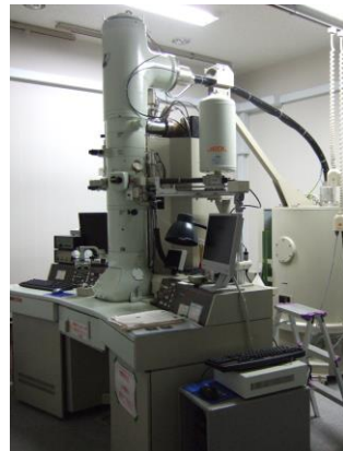
300kV透過電子顕微鏡(TEM) CCD+HRTEM: 高分解能(原子配列)
