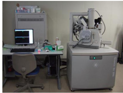
集束イオンビーム加工観察(FIB) FIB+SEM: デュアルビーム(DB) FIB: Gaイオンビーム Pt-deposition: 保護層形成 極細探針: 極微試料採取
